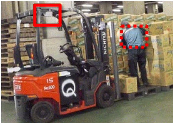
フォークリフトは天井、人は胸ポケットにトラッカーを取り付け
